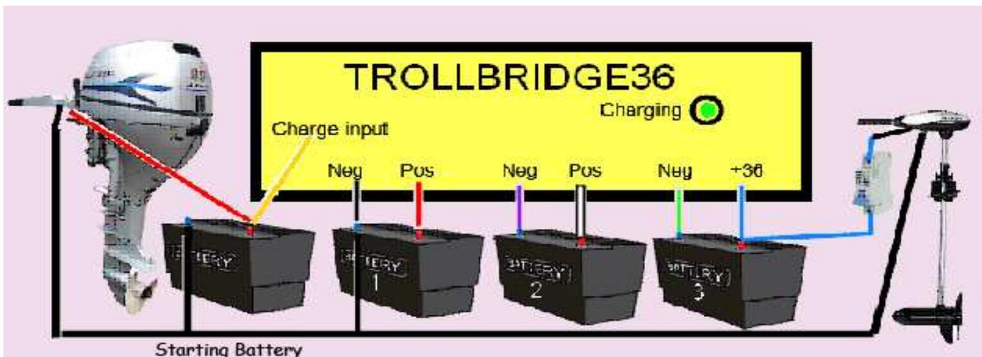
**ON 3 BATTERY SYSTEMS THE OUTBOARD USES TROLLING BATTERY #1 FOR STARTING**
